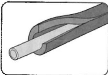
Avvolgere le tubazioni con tubo isolante flessibile in elastomero a celle chiuse per isolamento termico.
